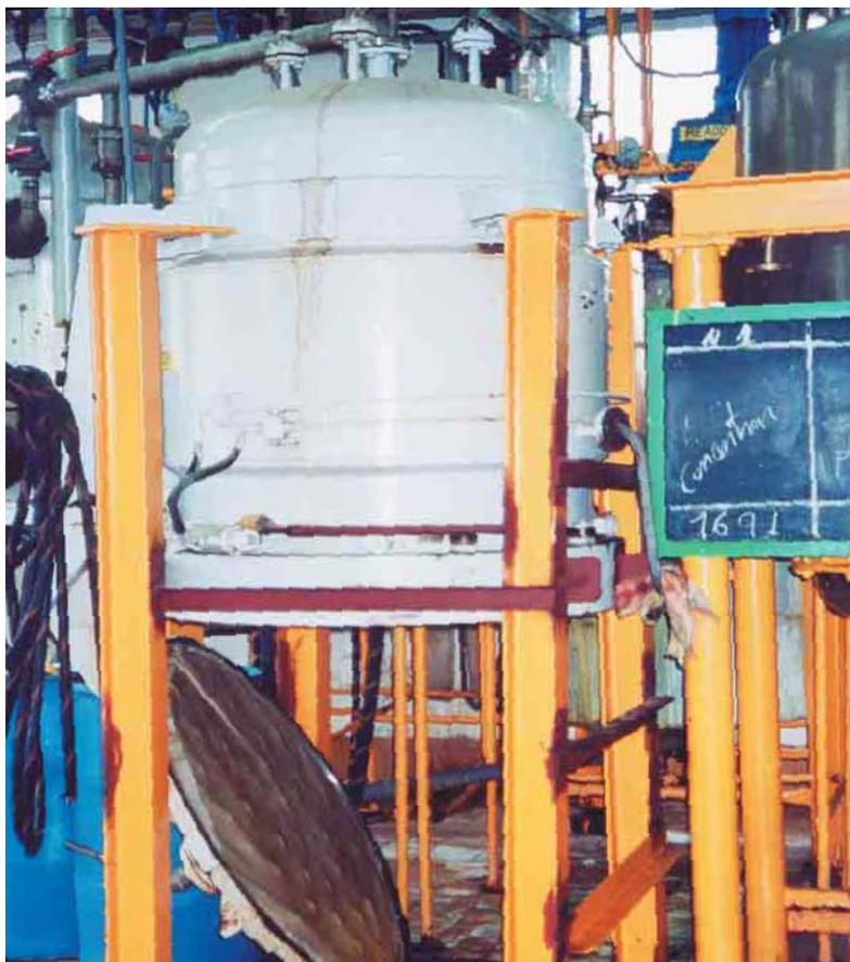
Al igual que en los **Filtros de Presión**, en la **Nucha Filtrante** la separación sólido/líquido tiene lugar gracias a la presurización del depósito.
